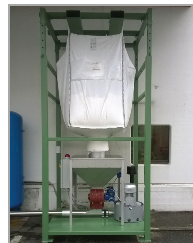
SCARICA BIG-BAG CON IMPIANTO DI SPINTA MATERIALE PER CARICO SILOS BIG-BAG UNLOADER WITH MATERIAL PUSHER SYSTEM FOR FILLING SILOS
