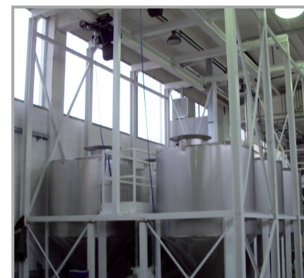
STRUTTURA SVUOTA BIG-BAG CON PIÙ PUNTI DI SCARICO BIG-BAG EMPTYING FRAME WITH SEVERAL DISCHARGE POINTS
