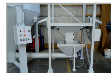
PARTICOLARE DEGLI ATTUATORI PER SCUOTIMENTO BIG BAG PART OF ACTUATORS FOR SHAKING BIG BAG
