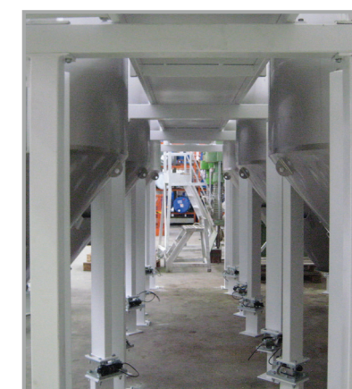
SILETTI AISI 304 CON STRUTTURA VERNICIATA SMALL AISI 304 SILOS WITH PAINTED FRAME
