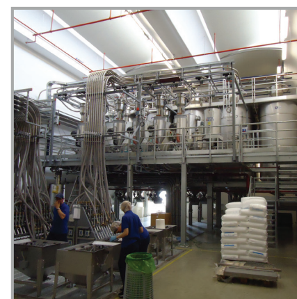
SILETTI INTERNI CON SISTEMA DI PESATURA SU STRUTTURA ZINCATA SMALL INDOOR SILOS WITH WEIGHING SYSTEM ON GALVANISED FRAME
