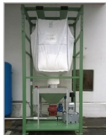
SCARICA BIG-BAG CON IMPIANTO DI SPINTA MATERIALE PER CARICO SILOS
