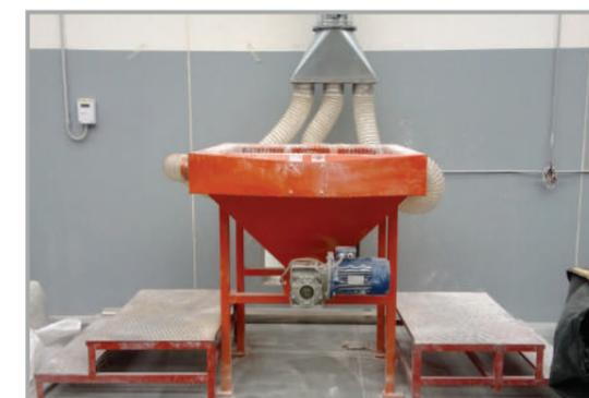
STAZIONE DI CARICAMENTO POLVERI ASPIRATA E TRASPORTO TRAMITE COCLEA
