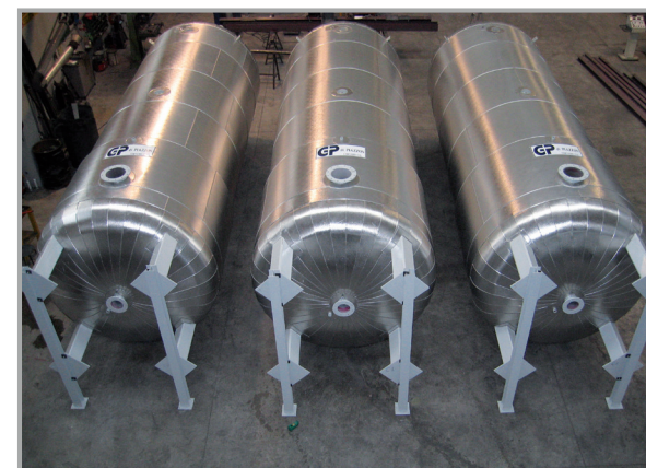
SERBATOI COIBENTATI PRONTI PER SPEDIZIONE INSULATED TANKS READY FOR SHIPPING
