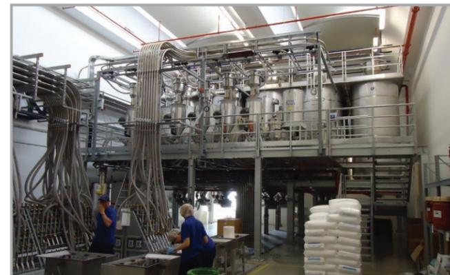
SILETTI INTERNI IN AISI 304 CON SISTEMA DI PESATURA PER SETTORE ALIMENTARE
