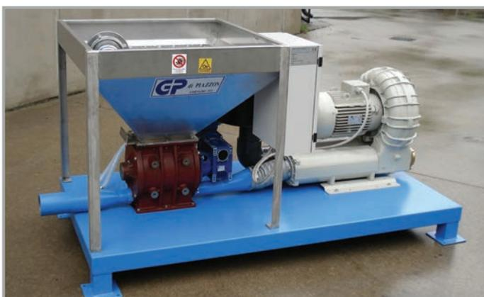
IMPIANTO DI SPINTA PNEUMATICO DA 6000 KG/H
