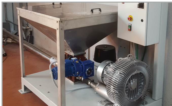
ZONA DI CARICO CENTRALIZZATO PER TRASPORTO IN SPINTA CENTRALISED LOADING ZONE FOR PNEUMATIC CONVEYORS
