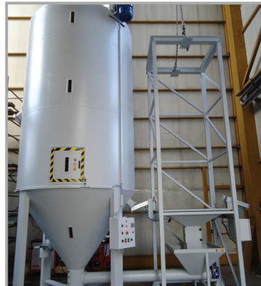
MESCOLATORE CON CARICAMENTO FORZATO E STRUTTURA SCARICA BIG-BAG MIXER WITH FORCED LOADING AND BIG-BAG EMPTYING
