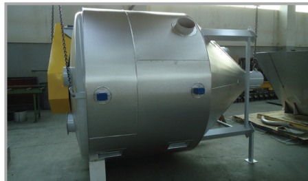
MESCOLATORE COIBENTATO CON SISTEMA DI PRERISCALDO INSULATED MIXER WITH PREHEATING SYSTEM
