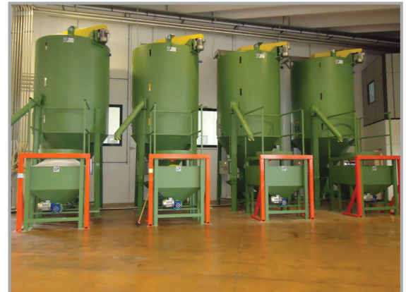
MESCOLATORI A COCLEA CON TRAMOGGINA DI CARICO FORZATO PER CARICO DA BIG-BAG SCREW MIXERS WITH FORCED LOADING HOPPER FOR LOADING FROM BIG-BAG
