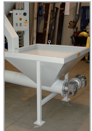
TRAMOGGINA PER CARICO DA SACCHI O BIG-BAG LOADING HOPPER BAG OR BIG-BAG
