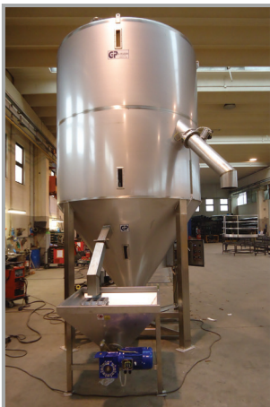
MESCOLATORE INOX 1400 L CON CARICAMENTO FORZATO 1400 L STAINLESS STEEL MIXER WITH FORCED LOADING
