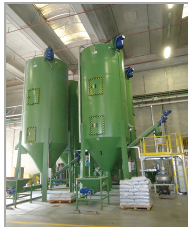
IMPIANTO DI MISCELAZIONE CENTRALIZZATO CON TRASPORTO A COCLEA CENTRALISED MIXING PLANT WITH SCREW CONVEYOR
