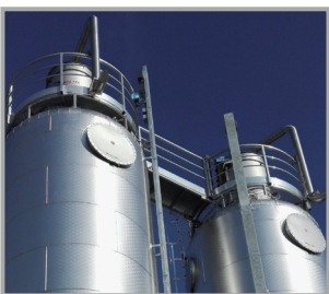
SILOS ATEX CON PANNELLI ANTISCOPPIO SU STRUTTURA IN FE ZINCATO ATEX SILOS WITH EXPLOSION VENT PANELS ON GALVANISED IRON FRAME
