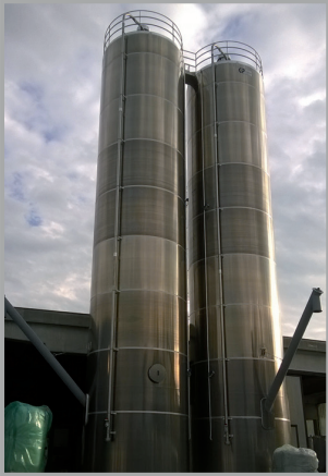
SILOS CON COCLEA ESTRATTRICE PER CARICO AUTOBOTTE SILOS WITH DISCHARGE SCREW FOR LOADING TANK TRUCKS
